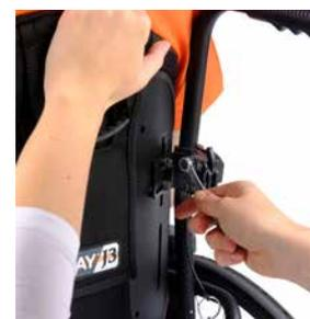
Ajuste en altura y anchura    Ajuste en profundidad
