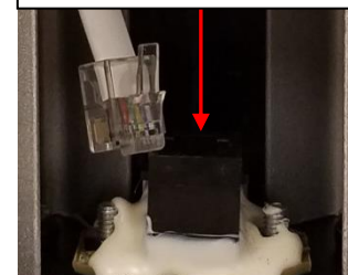
Cable de celda de carga
