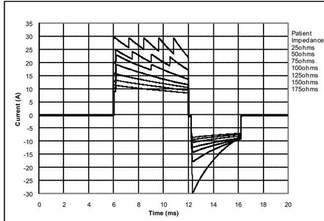
Figura 9: Formas de onda rectilíneas bifásicas a 200 julios
