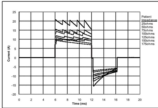
Figura 12: Formas de onda rectilíneas bifásicas a 85 julios
