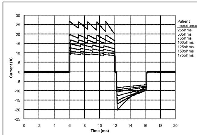
Figura 10: Formas de onda rectilíneas bifásicas a 150 julios
