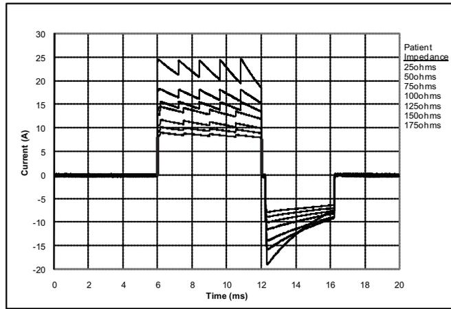
Figura 11: Formas de onda rectilíneas bifásicas a 120 julios
