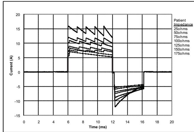
*Figura 14: Formas de onda rectilíneas bifásicas a 50 julios*
