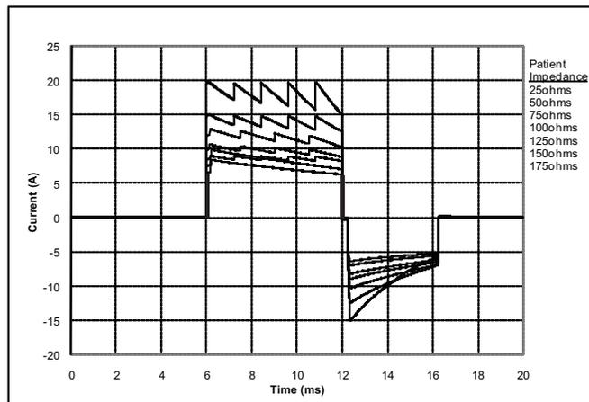
Figura 13: Formas de onda rectilíneas bifásicas a 70 julios
